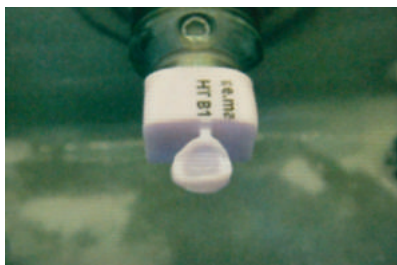
Рис. 108. Проведение фрезерования коронки из керамического блока
