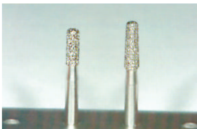
Рис. 56. Цилиндрический и конусовидный боры
