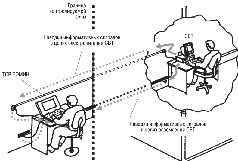
Рис. 2. Перехват информации с помощью средств разведки ПЭМИН по цепям электропитания и заземления
