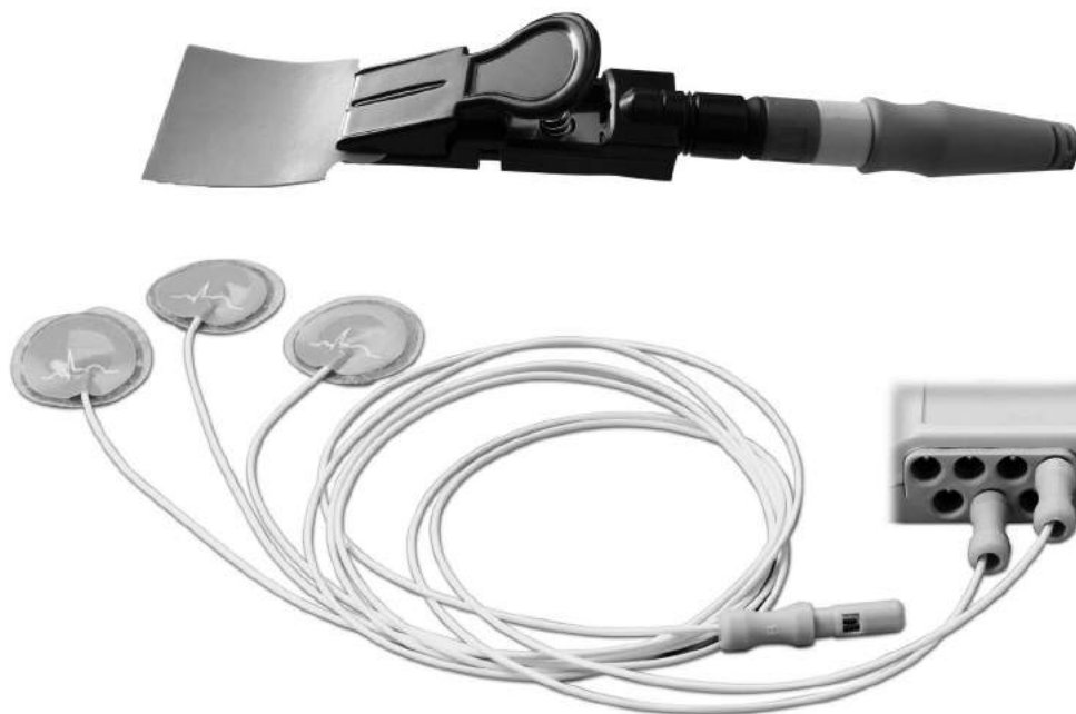
Рис. 35. Подключение электродов однократного применения с язычком к кабелю пациента (вверху) и электродов, оснащённых проводом (внизу)
