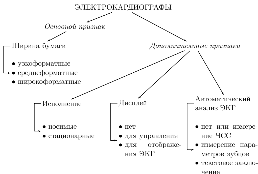
Рис. 4. Схема современной классификации электрокардиографов
