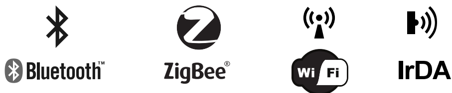
Рис. 24. Символы маркировки беспроводных интерфейсов
