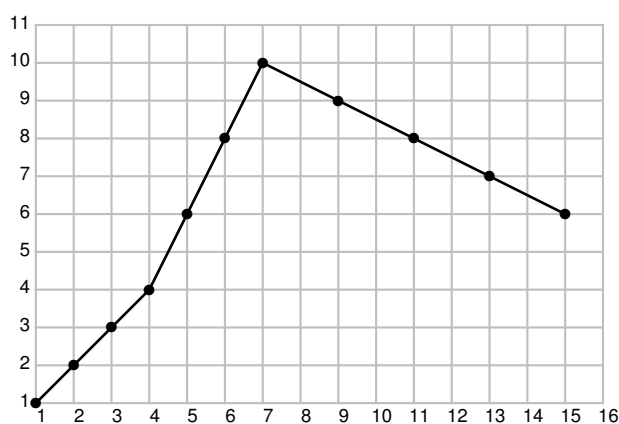
Рис. 9. Продолжение схемы аналого-цифрового преобразования: отмечены точки с целыми значениями ординат
