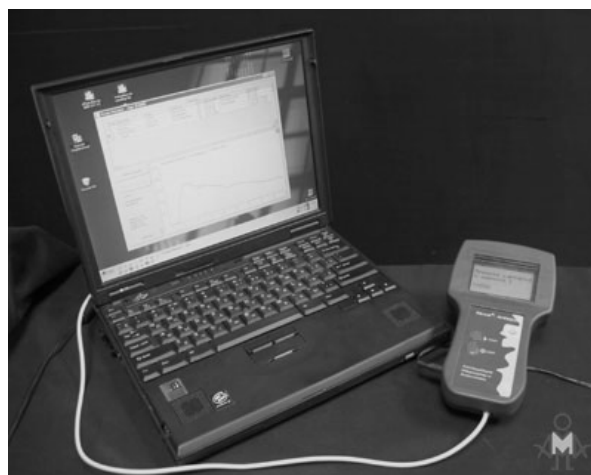
Рис. 6.3. Хелик-аппарат® ООО «АМА» для непрерывной регистрации концентрации аммиака
