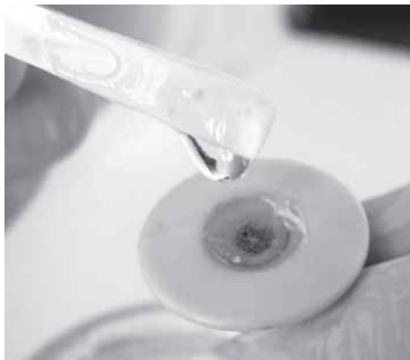
Рис. 4.22. Добавление с помощью пластиковой палочки пасты в полость электрода сравнения
