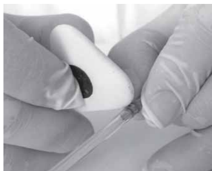
Рис. 4.12. Зачистка ластиком поверхности измерительных электродов
