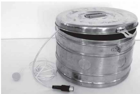
Рис. 4.11. Стерилизация рабочей части рН-зонда в контейнере
