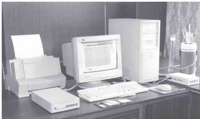
Рис. 5.3. «Гастроскан-5М» – компьютерный прибор для pH-метрии и диагностики состояния верхних отделов ЖКТ
