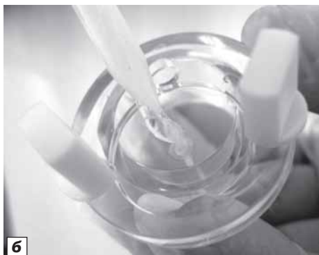
Рис. 4.17. Смачивание ниточного капилляра (а) и нанесение электродной пасты на насадку (б)
