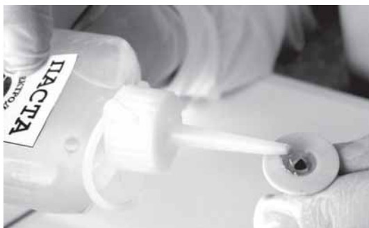
Рис. 4.8. Заполнение рабочей полости накожного электрода свежей электродной пастой
