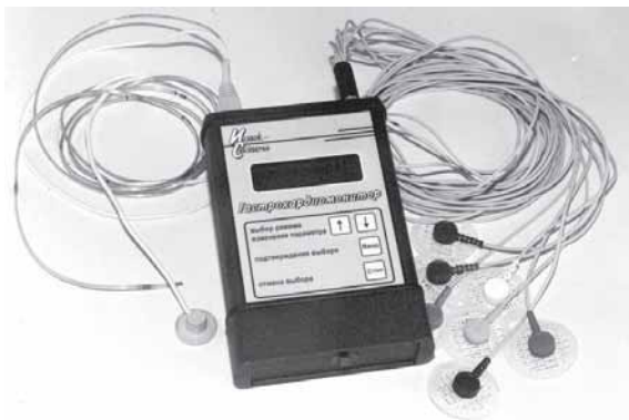
Рис. 5.17. «Гастроскан-ЭКГ» – компьютерный прибор для суточного мониторинга одновременно pH и электрокардиограммы
