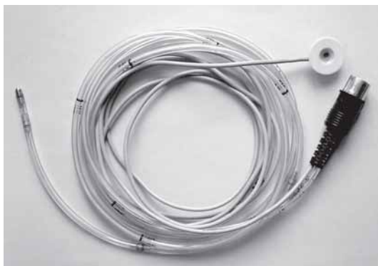
Рис. 4.3. Общий вид перорального pH-зонда
