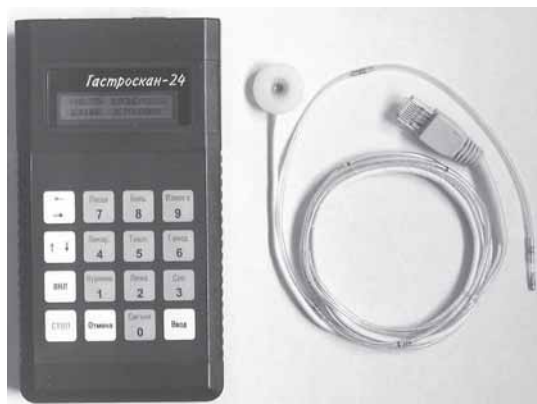
Рис. 5.14. «Гастроскан-24» – компьютерный прибор для суточного мониторинга рН
