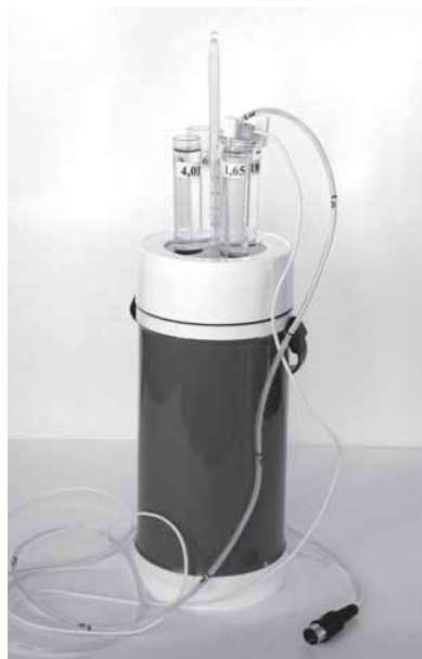
Рис. 4.14. Термостатированное приспособление для калибровки с пробирками
