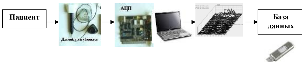
Рис. 18. Схема метода компьютерной бронхофонографии
