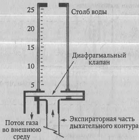
Рис. 1.14. Схематическое изображение гидростатического клапана РЕЕР. Поток газа из экспираторной части дыхательного контура направлен на диафрагму, утяжеленную столбом воды. Сила, противодействующая потоку газа, определяется весом столба воды и диафрагмы
