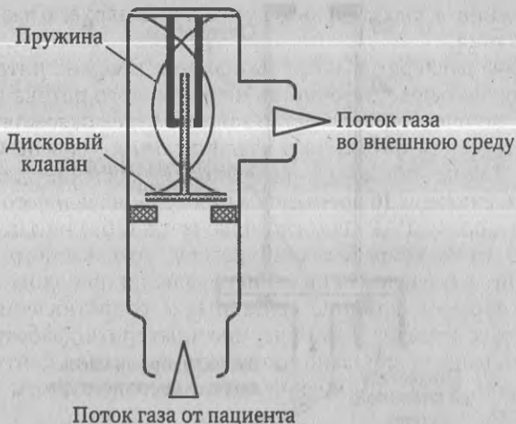
Рис. 1.15. Схематическая иллюстрация клапана РЕЕР с пружинным напряжением. Поток газа из экспираторной части дыхательного контура направлен против дискового клапана. Сила, противодействующая потоку газа, определяется напряжением пружины и весом дискового клапана, когда он в вертикальном положении
