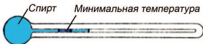
Рис. 2. Схема минимального термометра
