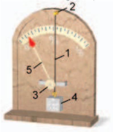
Рис. 7. Схема волосяного гигрометра
