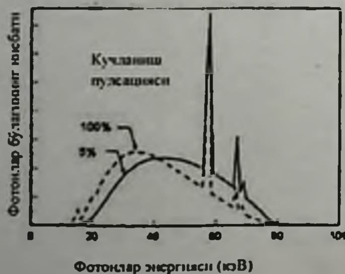
13 – расм. Рентгенологик нурланиш спектрига кучланиш пульсациясини таъсири
