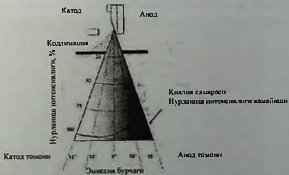
8 – расм. Нурланиш интенсивлигини анод қиялигига самараси.
