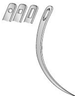
Р и с. 7. Закрытое ушко хирургической иглы с круглым, квадратным, прямоугольным и овальным просветами
