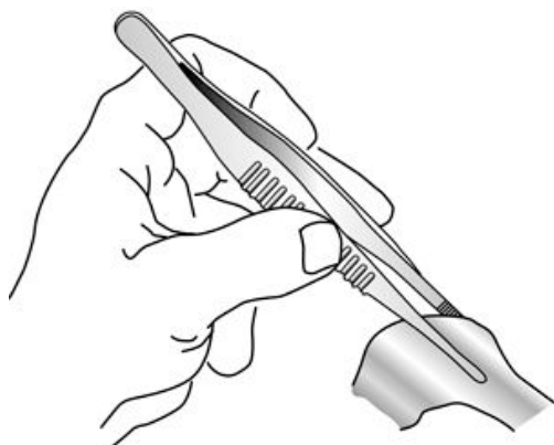
Р и с. 16. Использование всей площади рабочей поверхности пинцета
