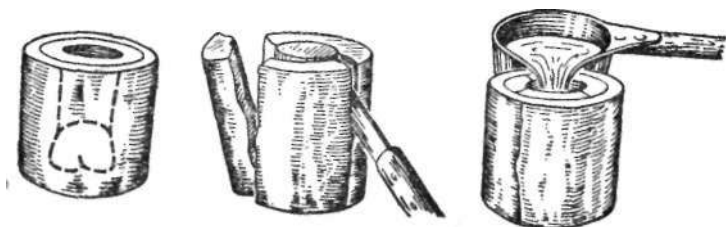
Рис. 14. Получение гипсовой формы для отливки металлического штампа.
